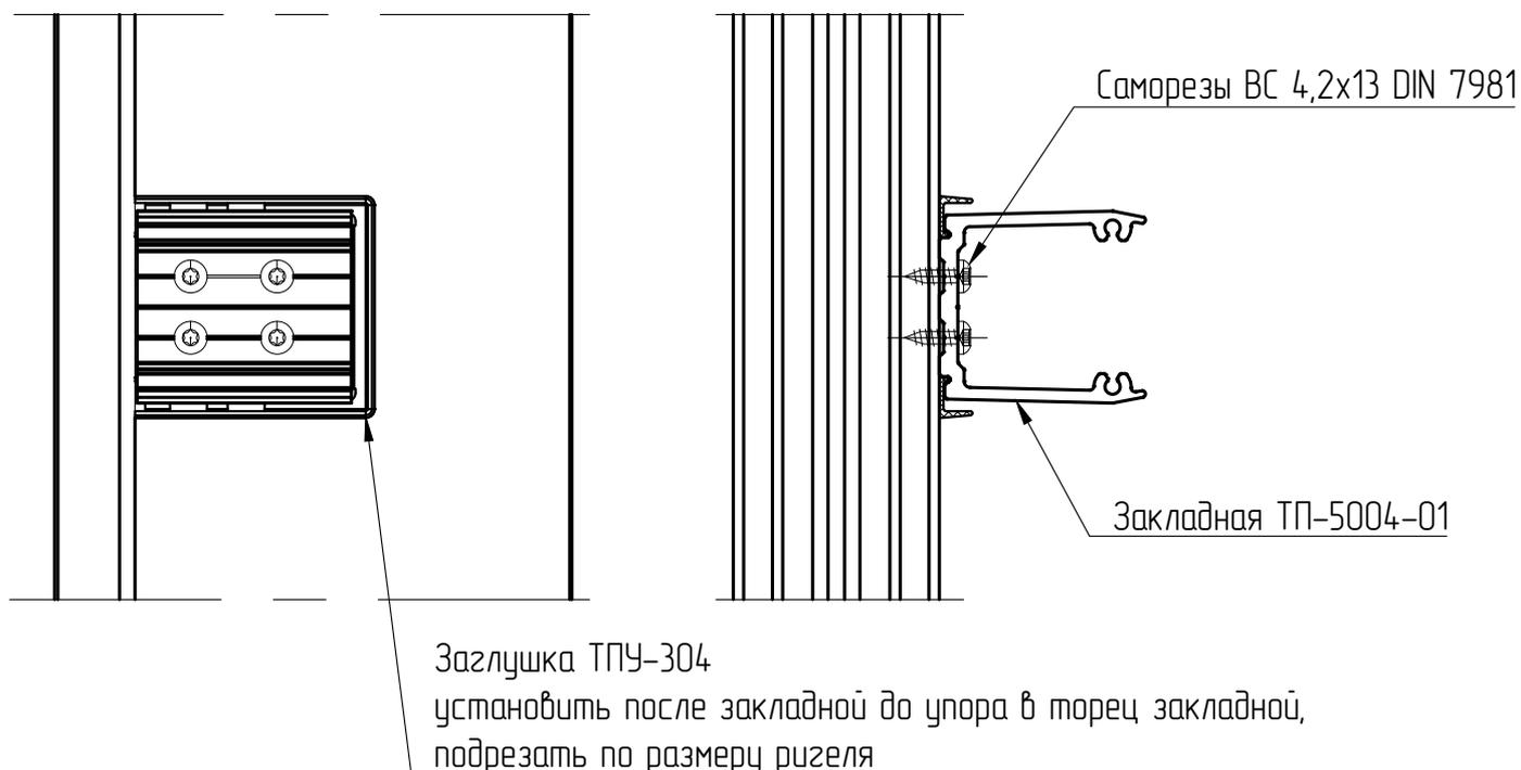
Схема обработки ригеля
